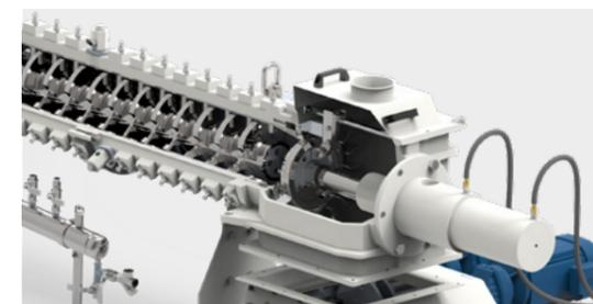
膨化機由一個厚壁混合管組成，該管具有可更換的耐磨鋼圈和一個懸臂軸，軸上配有送料、混合和揉捏的螺葉/螺絲元件。出口處的錐體可藉專利的液壓調節系統來調整與出口環共同形成環形間隙，
